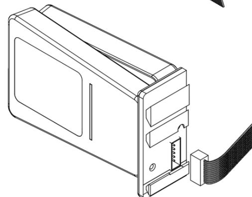
Schritt 6: Anschliessen des Scanner an Flachbandkabel
