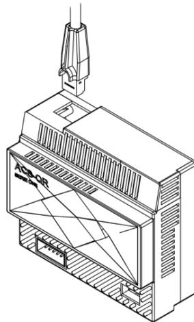
Schritt 4: Anschließen des LAN Kabel an das ACS System
