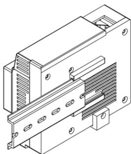
Schritt 2: seitliches Aufschieben des ACS System auf Hutschiene
