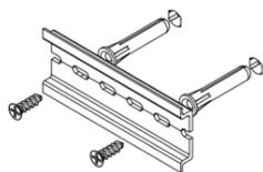
Schritt 1: Befestigen der Hutschiene
