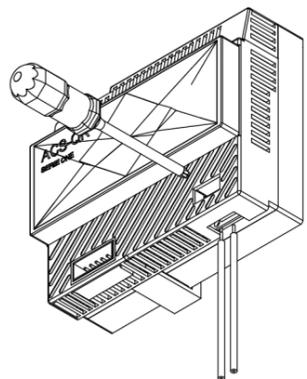
Schritt 3: Anschließen der 2 Kabel vom Türöffner an das Relais
