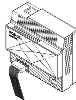
Schritt 5: Anschließen des QR Scanners an das ACS System
